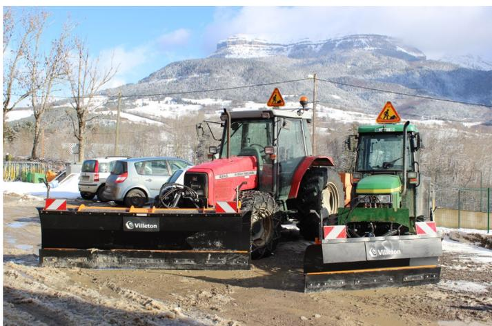
La commune s'est équipée pour améliorer le déneigement en se dotant de nouvelles étraves remplaçant ainsi les anciennes usées et devenues obsolètes. Ces nouveaux matériels dotés d'un système hydraulique moderne permettent de diriger dans plusieurs sens les étraves montées sur les tracteurs communaux. Ce dispositif facilite la tâche des employés et permet un déneigement plus précis de nos routes et chemins communaux.
