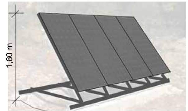
Exemple de pose de capteurs solaires au sol, sans modification de la topographie naturelle. La hauteur maximale est mesurée entre le terrain naturel et le point le plus haut de l'installation ; nappe composée de plusieurs panneaux alignés sur structure de teinte sombre
