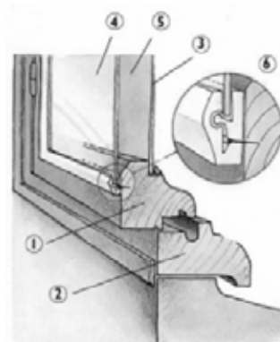
1. Survitre nue démontable sur ouvrant (d'après doc. Édusud). 1 Ouvrant 2 Dormant 3 Vitrage existant 4 Survitrage 5 Lame d'air 2 à 3 cm 6 Détail du joint souple cloué sur ouvrant
