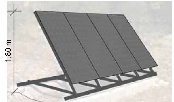
Exemple de pose de capteurs solaires au sol, sans modification de la topographie naturelle. La hauteur maximale est mesurée entre le terrain naturel et le point le plus haut de l'installation ; nappe composée de plusieurs panneaux alignés sur structure de teinte sombre
