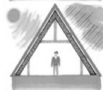
< Schéma d'illustration : isolation des rampants en cas de comble aménagé - Source : fiches ATHEBA
