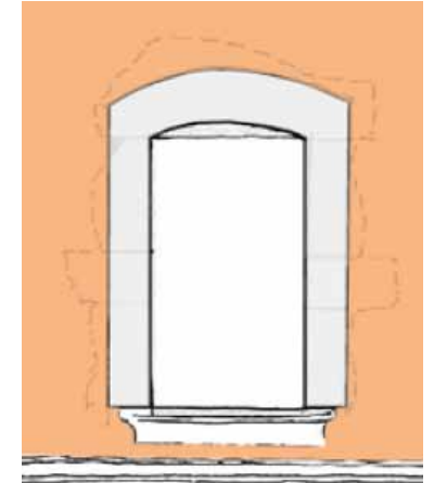
Encadrement en pierre couvert par l'enduit, badigeon peint faisant encadrement
