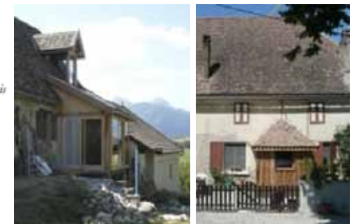
Espaces tampons créés en façade : véranda, sas d'entrée
