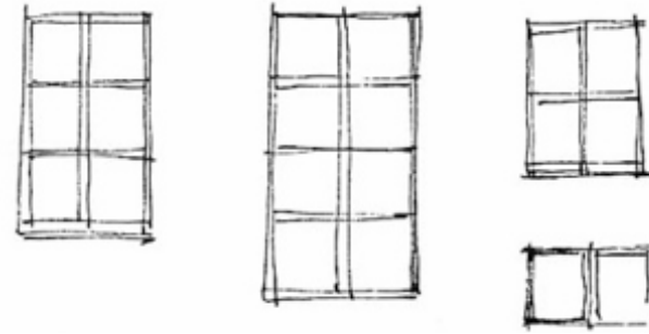
Exemple de proportion des menuiseries de fenêtre en bois existantes : les carreaux sont légèrement verticaux, 30x35 ou 35x40.
